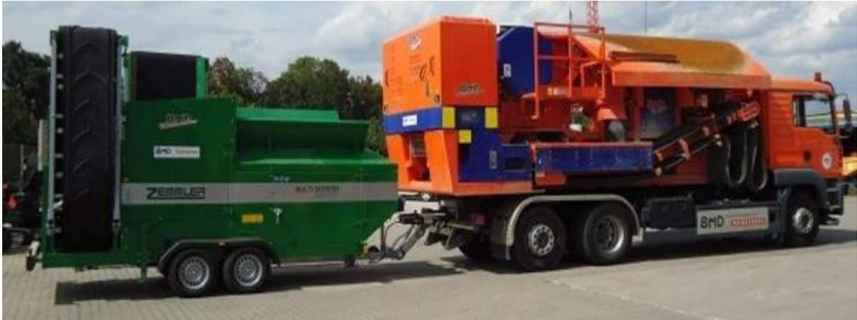
**Figura 37: Exemplo de usina de reciclagem móvel de resíduos da construção civil – URM-RCC.**
